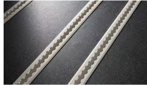
Alu-Leichtbauboden mit PVC-Bodenbelag und drei Airline-Schienenpaaren
