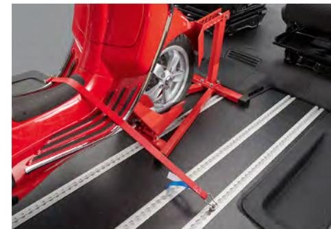
Motorrad-Halterung mit Wippe zur Gurtfixierung auf dem Alu-Leichtbauboden
