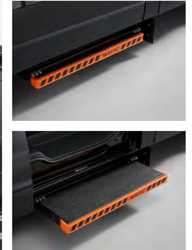
Die Trittstufe fährt automatisch beim Öffnen der Schiebetür heraus
