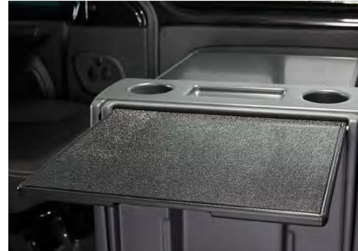
Tisch mit ausklappbaren Platten und umlaufenden Kanten auf beiden Seiten sowie praktischen Flaschen- und Becherhaltern
