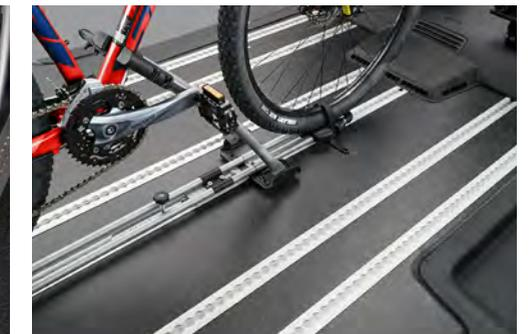
Einfach und sicher auf den Schienen zu montierende Fahrradhalterung
