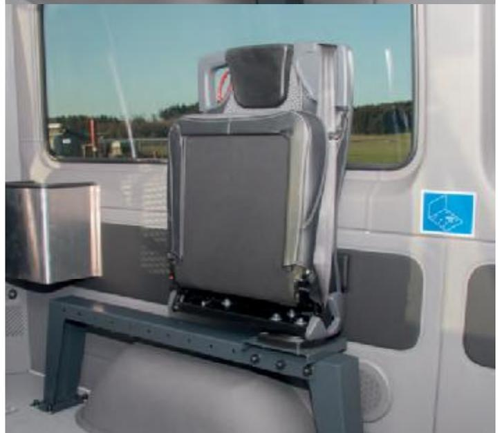
**Triflex Air** - Mit wenigen Handgriffen kann der Drehklappsitz in die gewünschte Position gedreht werden.
