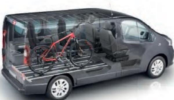
4 Einzelsitze mit Fahrradhalterung (Fahrer- & Beifahrersitz drehbar)
